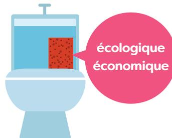
**5** Je mets une brique dans le réservoir des WC pour réduire le volume de la chasse...
