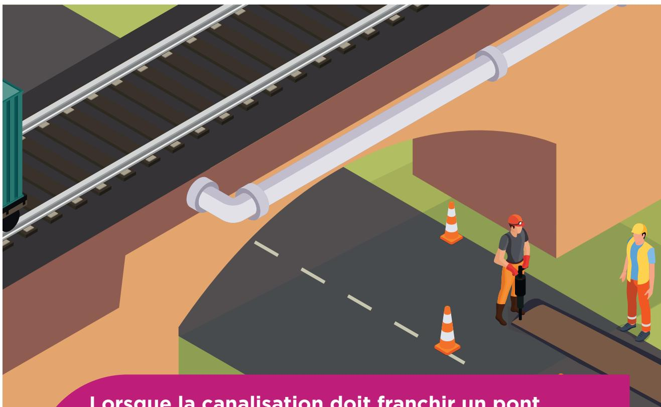
**Lorsque la canalisation doit franchir un pont, ponceau ou aqueduc, et également lorsqu'elle est située à proximité d'un mur de soutènement, une étude spécifique précisera les modalités de franchissement en fonction de la nature de l'ouvrage.**
